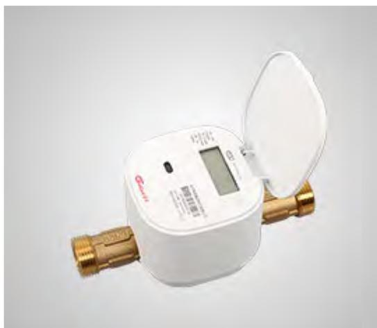
Бытовой ультразвуковой счетчик воды LXC использует разницу между временем прямого и обратного распространения ультразвуковых волн в жидкости для определения средней скорости газа в звуковом канале, тем самым вычисляя расход жидкости. Он обладает такими преимуществами, как низкий пусковой расход, широкий диапазон передаточных чисел, высокая точность, высокая стабильность, высокая
