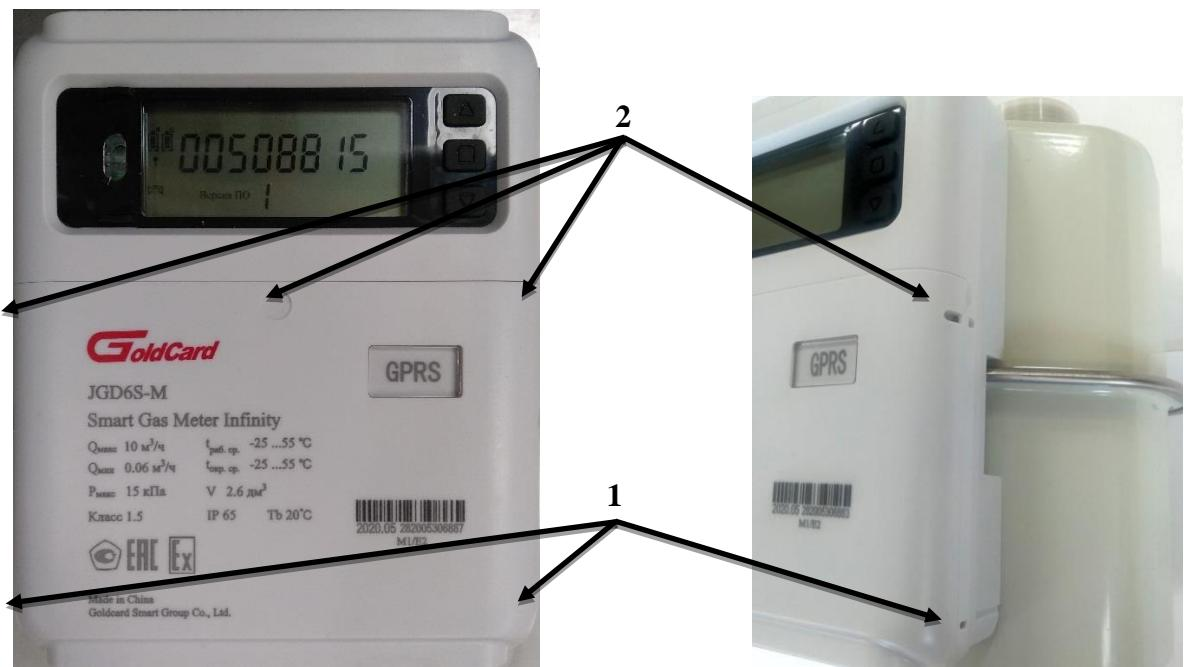
Рисунок 2 – Схема пломбировки от несанкционированного доступа, обозначения места нанесения знака поверки счетчиков газа диафрагменных Smart Gas Meter Infinity (1 – место для установки знака поверки, 2 – место для установки пломбы поставщика газа)
